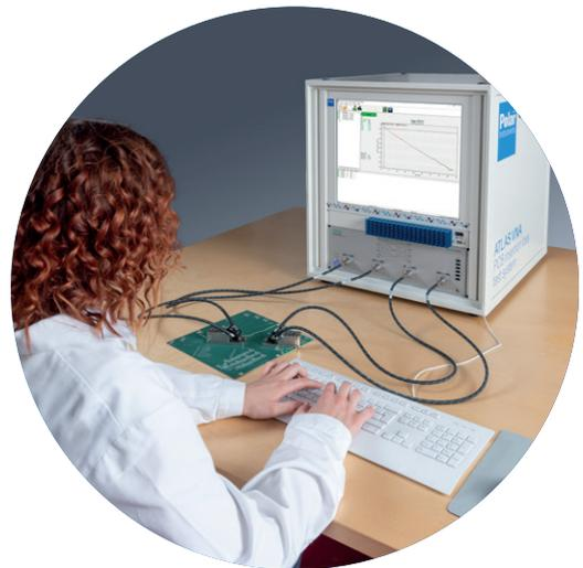
ATLAS VNA ist ein schlüsselfertiges System und enthält alle erforderlichen Prüfspitzen und Kabel.
