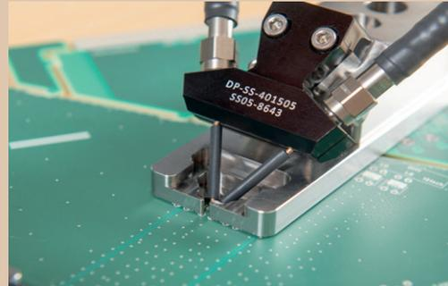
Ein Paar von Delta-L 4.0 Präzisions-Probes stellt optimale Signaleinkopplung sicher
