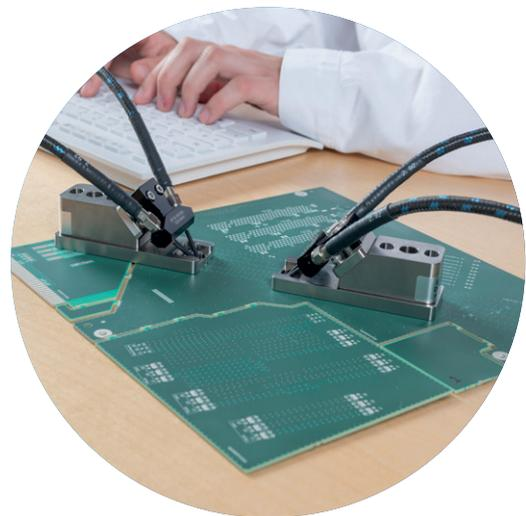
Die Delta-L 4.0 De-Embedding-Technik eliminiert den Einfluss der Kontaktierung und extrahiert den Dämpfungsanteil der Leiterbahn
