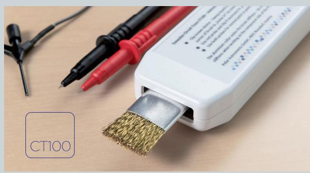
Die optional erhältliche **CT100** Leiterbahn-Bürste dient zum raschen Analysieren von Schaltungsnetzen an undokumentierten Baugruppen. Mit einer leitfähigen Bürste können Leiterbahnverläufe verfolgt und verbundene Bauteile identifiziert werden. Ein unentbehrliches Hilfsmittel für die Reparatur an Baugruppen ohne Schaltungsdokumentation.
